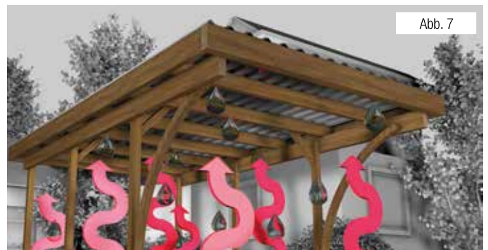
Feuchtigkeit steigt nach oben und bildet Kondenswasser, das ohne richtige Lüftung von dem Dach abtropfen kann. Deshalb muss für ausreichend Luftstrom gesorgt werden.
